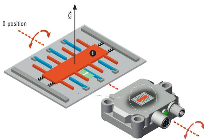
Le déplacement **2** d'une masse d'essai **1** modifie la distance et donc la capacité **F** entre les électrodes fixes **3** et électrodes mobiles **4** dans la cellule de mesure. Cette capacité mesurée est en relation directe avec l'inclinaison du capteur.
